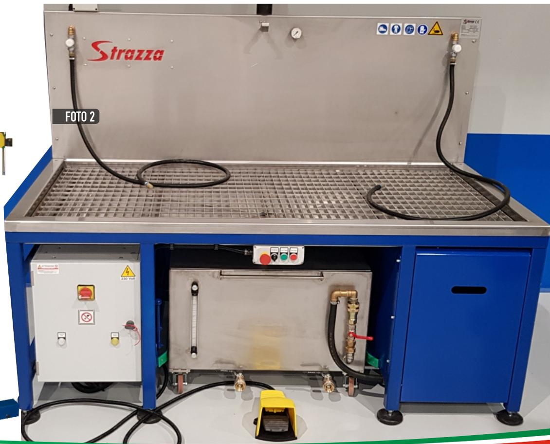
FOTO 1 CARRELLINO MOVIMENTAZIONE SHELL - FOTO 2 TEST LIQUIDI PENETRANTI GUSCI CERAMICI
