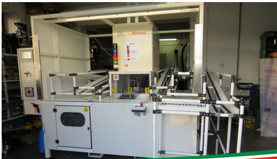
POSTAZIONI e LINEA ASSEMBLAGGIO E CONTROLLO PEDALIERE
